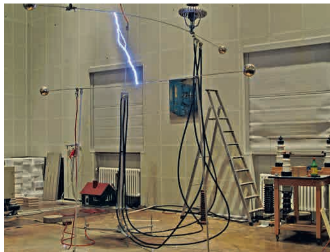
Figure 6: Test haute tension selon IEC TS 62561-8 Edition 1.0 de janvier 2018 d'un système HVI avec quatre conducteurs HVI.
