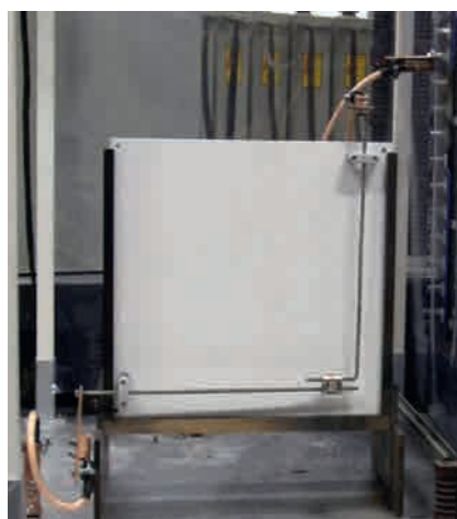
Figure 5: Échantillon fixé sur plaque isolante (borne MV) pour un test dans le laboratoire de courant de choc.
