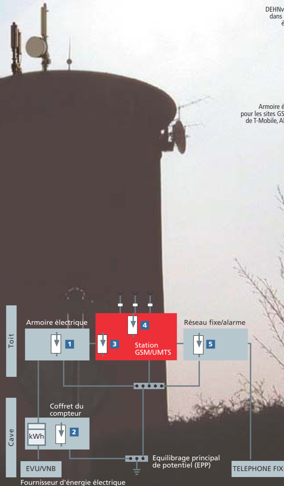
DEHNbloc®/3 et DEHNgap B/n dans le coffret du compteur
