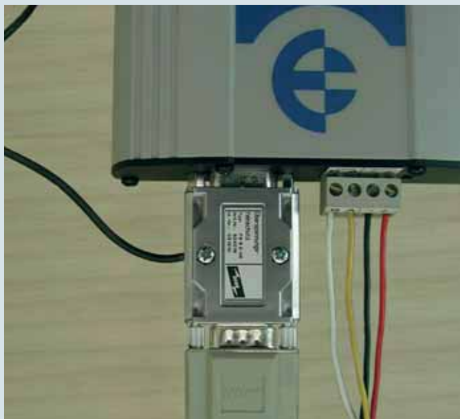
Adaptateur de protection antisurtension, raccordement Sub-D en version prise mâle-prise femelle.
