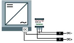
Le schéma montre la connexion d'un string à l'onduleur au moyen de 2 câbles AL DCU Y PV. Le câble type AL DCU X PV convient pour raccorder 2 strings sur l'onduleur.
