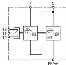
Schéma de principe du circuit DVA CSP 1P 50 S FM
